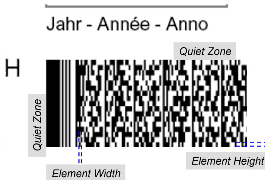
Figure 2.1. Description des éléments du code-barres 2D (PDF417)
