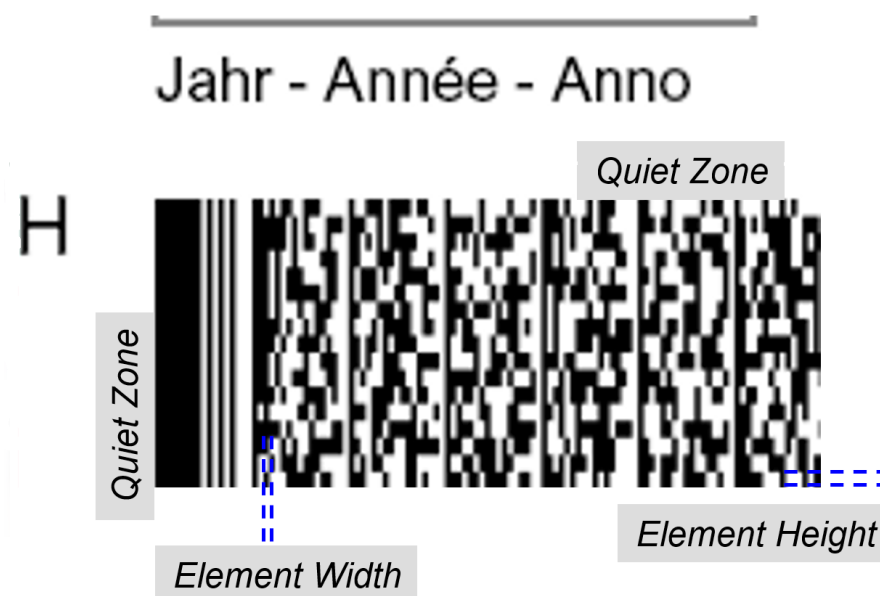
Figura 2.1. Descrizione degli elementi del codice a barre 2D PDF417
